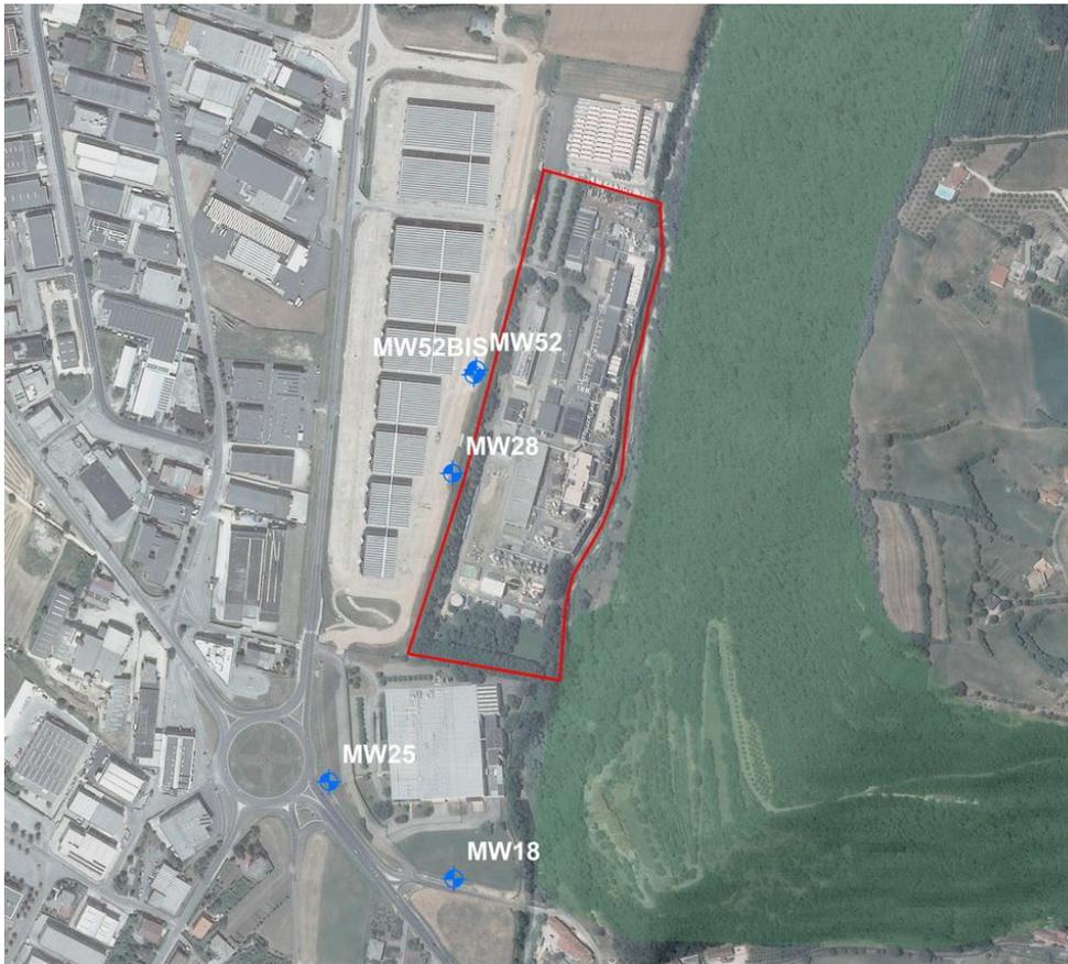
Il piezometro di controllo più importante, ai fini della verifica dell'efficacia della barriera idraulica, è quello denominato MW 18, a valle dello stabilimento, posizionato a circa un centinaio di metri fuori di esso.
